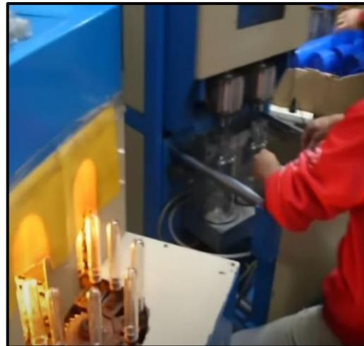
Ilustración 37: Calentamiento de preforma.
