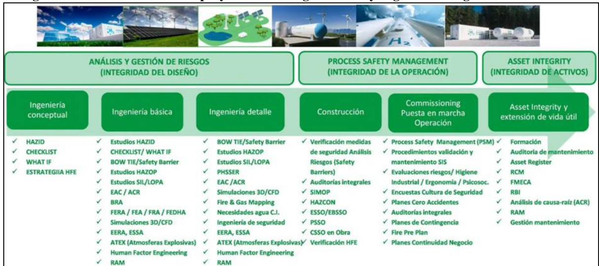
Figura 0-13 Ciclo de vida de un proyecto de Hidrogeno Verde y la gestión de seguridad
