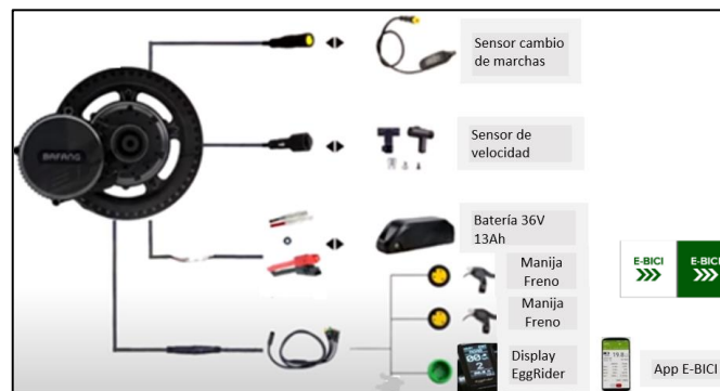
Figura N.º 7.4. Kit base, display y App E-BICI.
