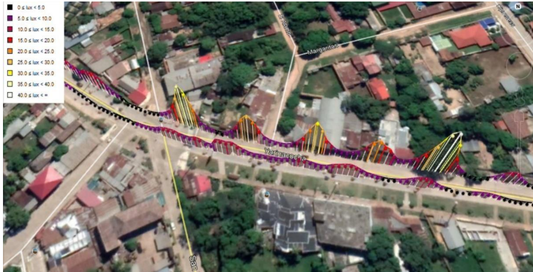
Niveles de Iluminación en un tramo de la Avenida Sánchez Carrión
