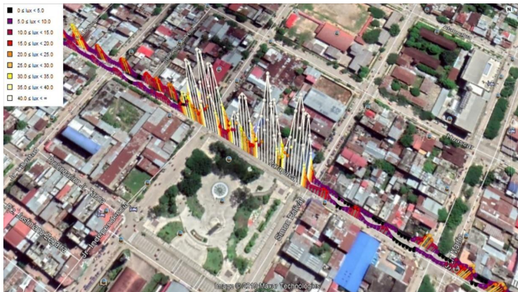
Niveles de Iluminación en un tramo de la Avenida Guillermo Sisley
